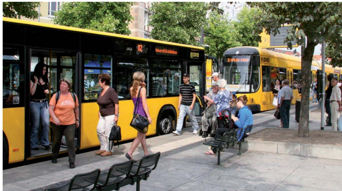
Der patentierte Dresdner Combibord ermöglicht es Straßenbahn und Bus gleichermaßen gut, an den Bahnsteig heranzufahren.
